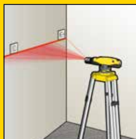
◀ Nivelação e alinhamento horizontal e vertical
